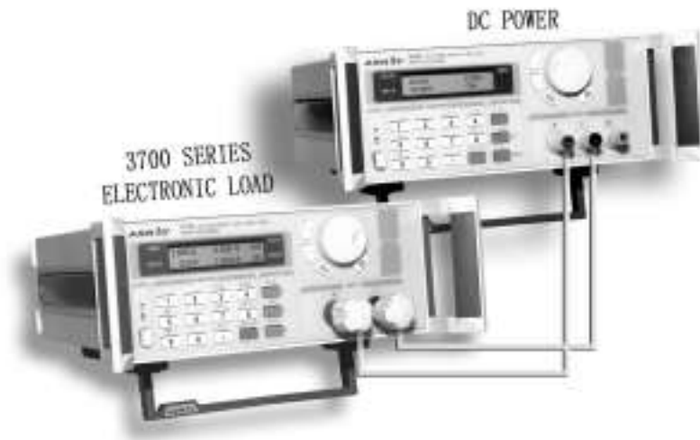
Bild 2-1 Schließen Sie die DC-Spannungsquelle an die elektronische Last an
